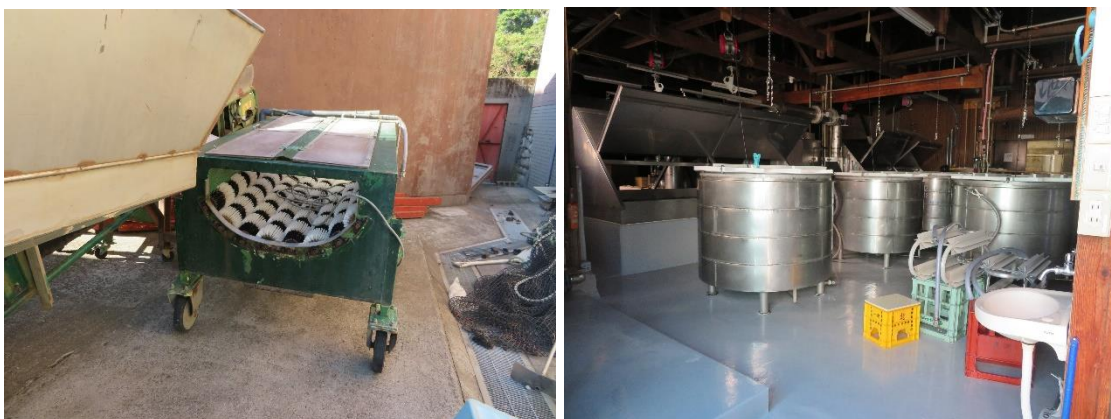
原料の芋を洗う機械（左）、ステンレス製のタンク（右）
